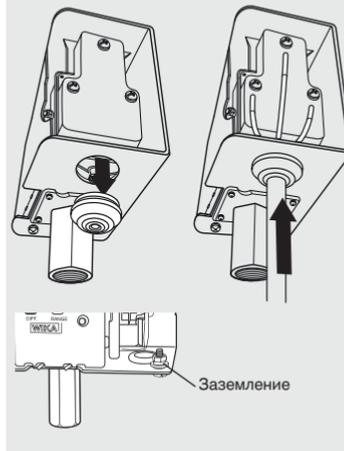
3. Подключите проводники в соответствии с функцией переключения, макс. момент затяжки: 2 Нм (18 фунт сила дюйм)
